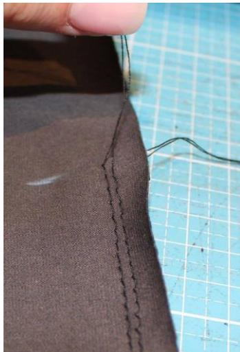
Beginne nun 10-15 cm unter der Achsel nach am Rand die Seite des Vorderteils abzunähen. Hierfür nimmst du einen Steppstich, den du auf maximale Länge deiner Maschine einstellst.
